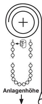
Für die obere und untere Endlage die beiliegenden Kettenstopper montieren
